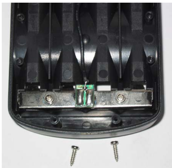
Obr.6 – Zaletovaný přívodní vodič na plošný spoj kontaktních pružin
